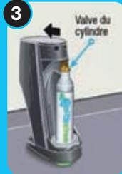
Inclinez la machine vers l'avant et vissez le cylindre.
