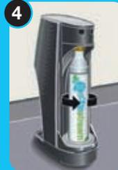
Vissez dans le sens des aiguilles d'une montre jusqu'à ce qu'il s'immobilise. Serrez à la main seulement. N'utilisez pas d'outil.
